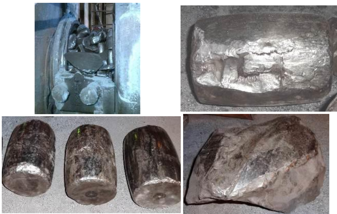
Рисунок 6 – Разрушение подшипника опорного кольца
