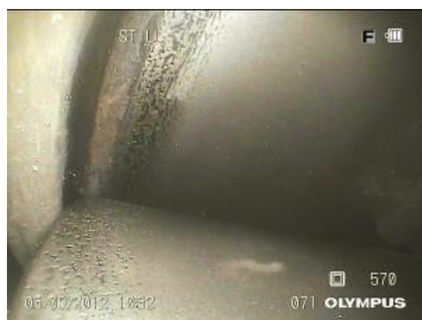
Рисунок 4 – Характерный износ тел качения подшипника опорного кольца конвертера
