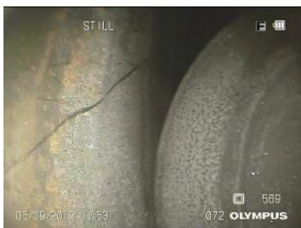
Рисунок 4 – Характерный износ тел качения подшипника опорного кольца конвертера
