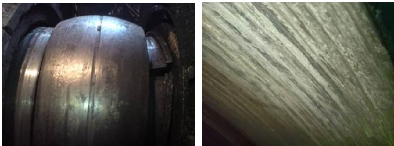
Рисунок 5 – Повреждения подшипника скольжения
