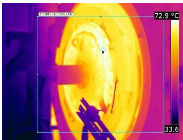
Рисунок 8 – Термограмма корпуса подшипника опорного кольца
