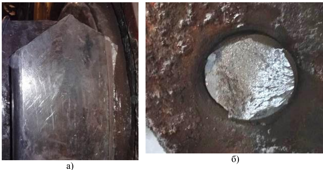
Рисунок 7 – Полированная посадочная поверхность наружного кольца (а) и разрушенный болт корпуса подшипника (б)
