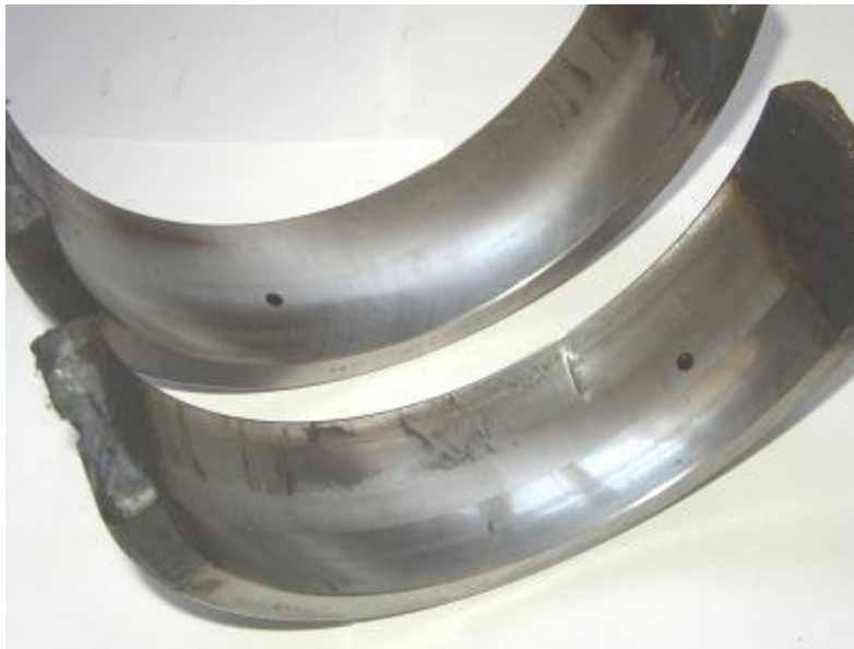
Рисунок 4 – Следы неравномерного износа наружного кольца подшипника
