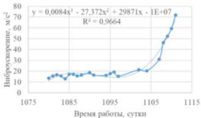
Рисунок 3 - Уравнения линии трендов развития повреждений подшипника для этапов: а) начального; б) заключительного
