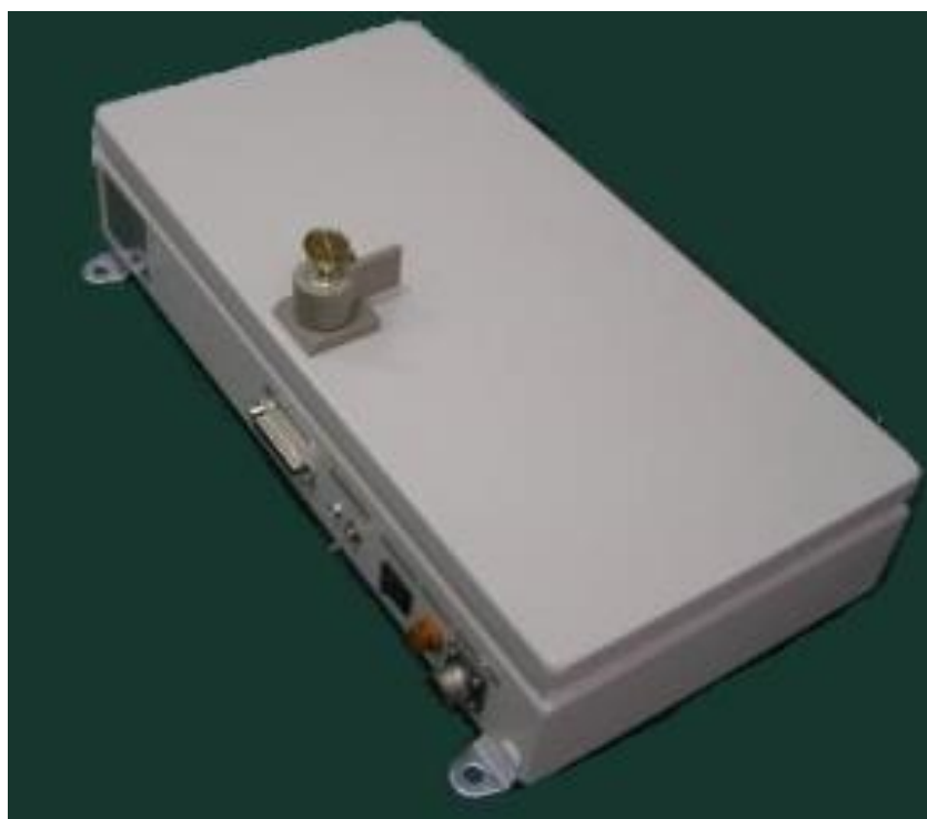
Рисунок 5 – Блок коммутации стационарной системы мониторинга и углубленной диагностики CMS (с параллельно-последовательным опросом)
