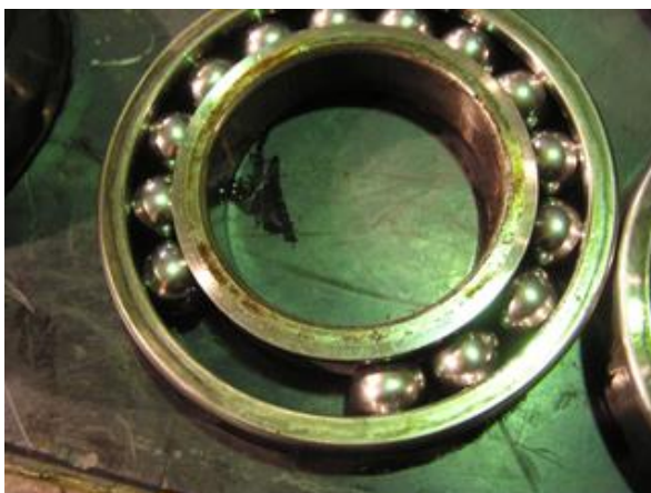
Рисунок 9 – Повреждения подшипников редукторной кассеты,
