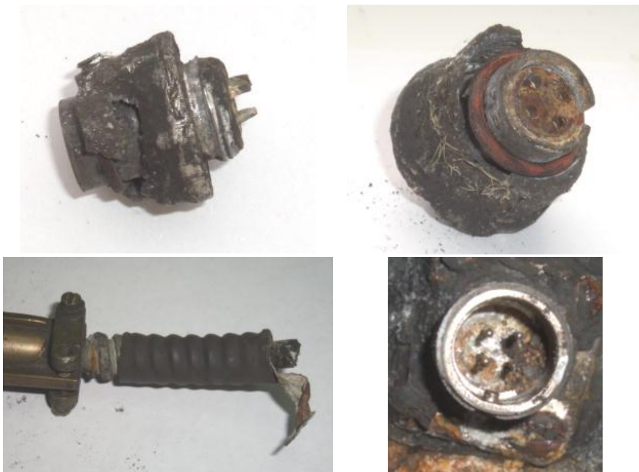
Рисунок 6 – Коррозия коммутрующих элементов
