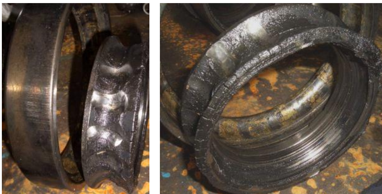
Рисунок 3 – Повреждения радиально-упорного шарикоподшипника из-за недостатка смазочного материала
