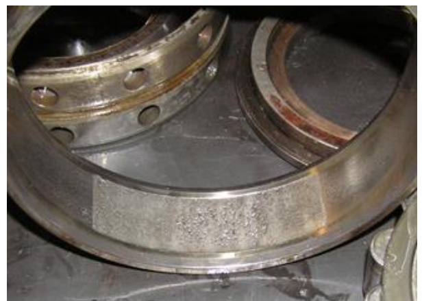
Рисунок 9 – Повреждения подшипников редукторной кассеты,
