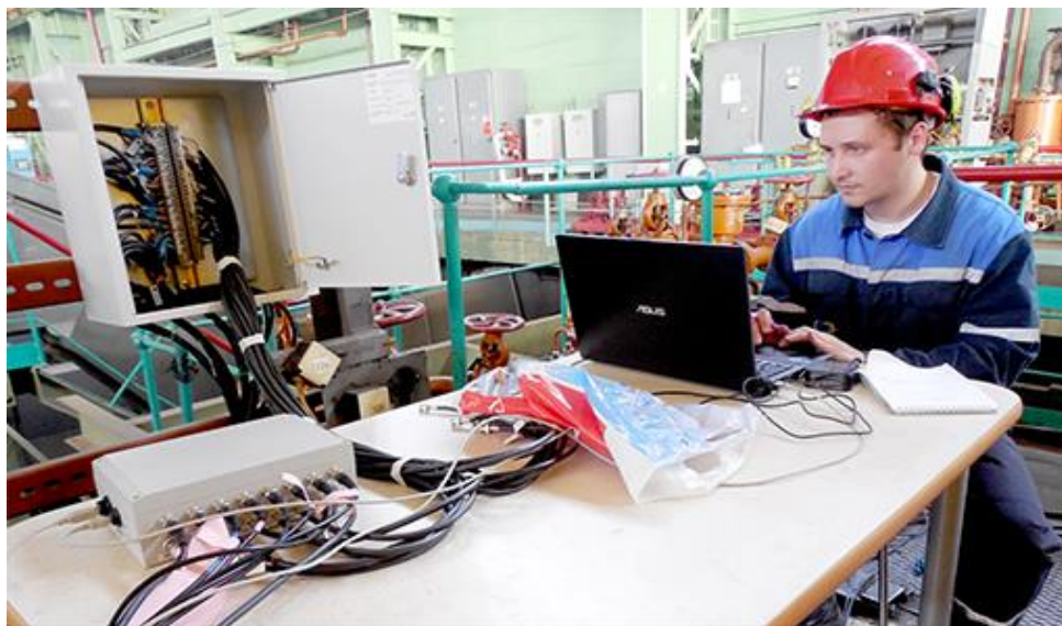
Рисунок 4 – Просмотр различных вибрационных характеристик в процессе разгона турбины в режиме реального времени на переносном ноутбуке с ПО SAFE PLANT, подключенном к измерительному блоку UMS-16
