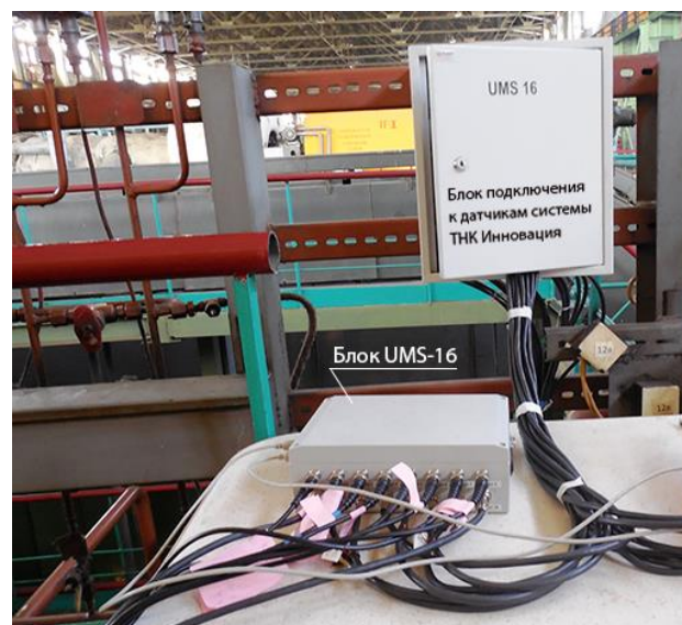
Рисунок 1 – Подключение многоканального виброизмерительного комплекса к первичным преобразователям системы «Вектор»
