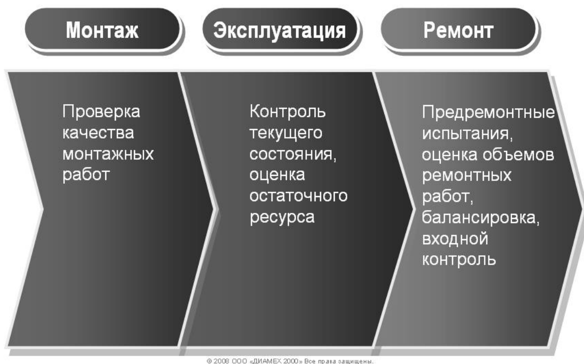
Рис. 1. Область применения технологий вибрационной диагностики на различных этапах жизненного цикла роторного оборудования.
