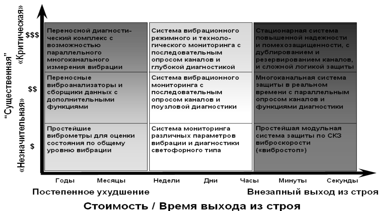
Рис. 2. Обобщенная диаграмма выбора оптимального технического решения.
